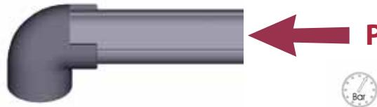
**I. Periodo de secado:** depende de la temperatura ambiente y tolerancia entre accesorios. Los encolados curan lentamente a bajas temperaturas y rápidamente a altas temperaturas. No es recomendable encollar a una temperatura inferior a 5°C. Se recomienda no aplicar presión superior a 1,5 bar antes de 24 horas.
