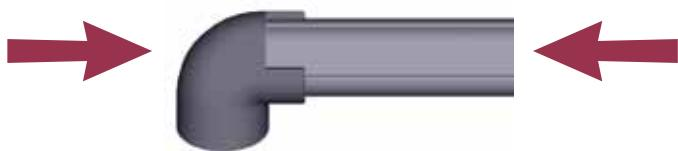
**H. Dejar secar la unión sin moverla durante 5 min para D≤63 y 30 min para diámetros superiores.**
